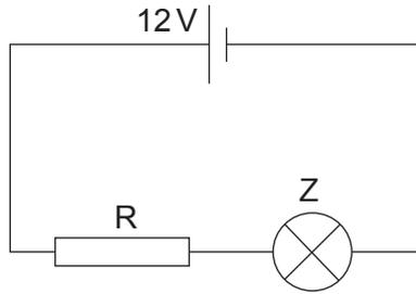
Determine, a partir del gráfico, la potencia disipada en la lámpara Z.
