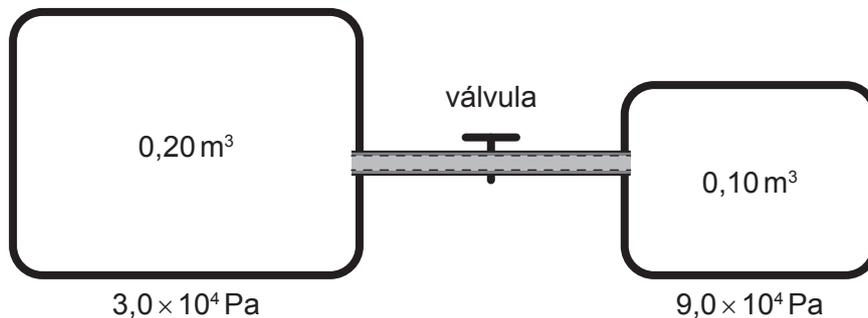
Se abre la válvula de modo que el gas pueda desplazarse de un contenedor a otro. La temperatura permanece sin cambios.
